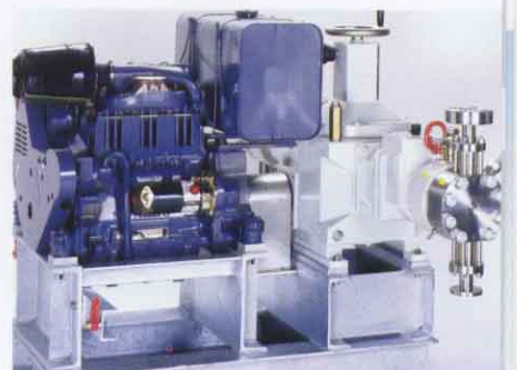
...在没有电源的情况下可选用内燃机或太阳能驱动形式。
